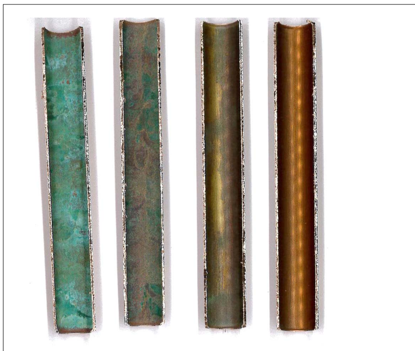
Figur 3-6 Rören efter 40 veckors exponering. Rören till höger har spolats med vanligt vatten (rör nr 6) och rören till vänster med filtrerat vatten. (Röret längst till vänster är den undre delen av röret.)
